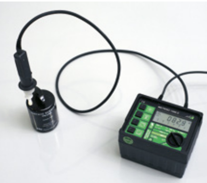
Abb. 1: Messung mit 2,5-kg-Messelektrode
